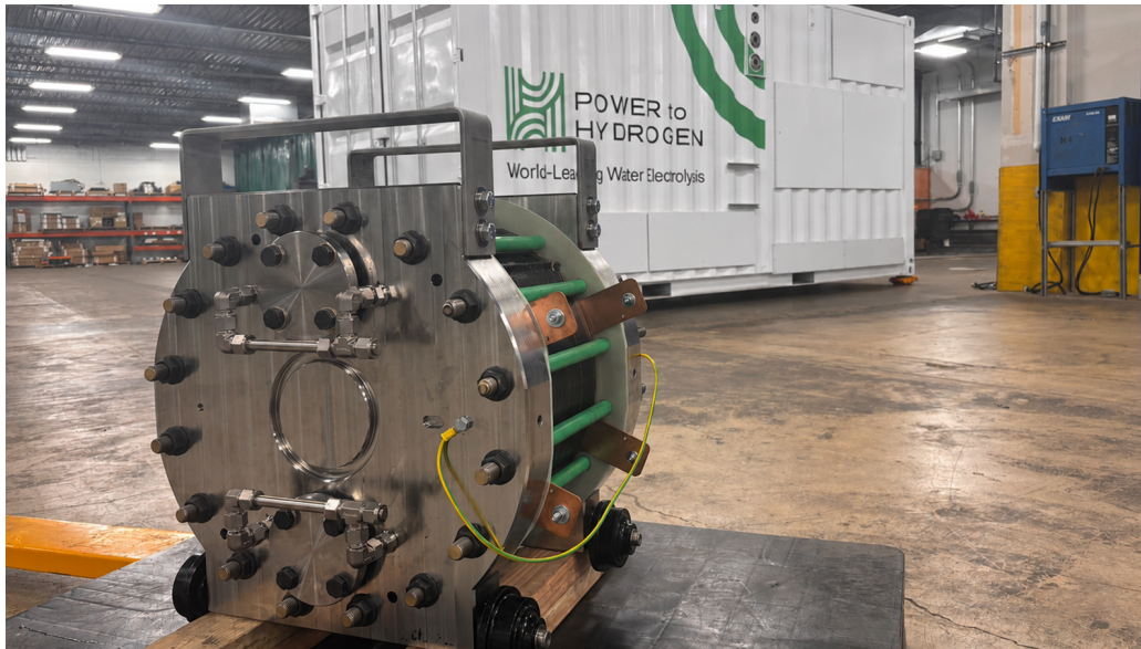
Power to Hydrogen y Repsol prueban con éxito un electrolizador AEM que reduce el coste del hidrógeno renovable.
