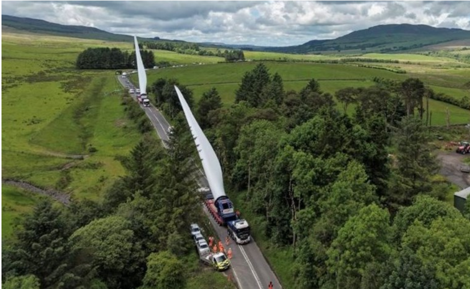
El convoy utiliza tecnología de elevación de palas por primera vez en el Reino Unido.
