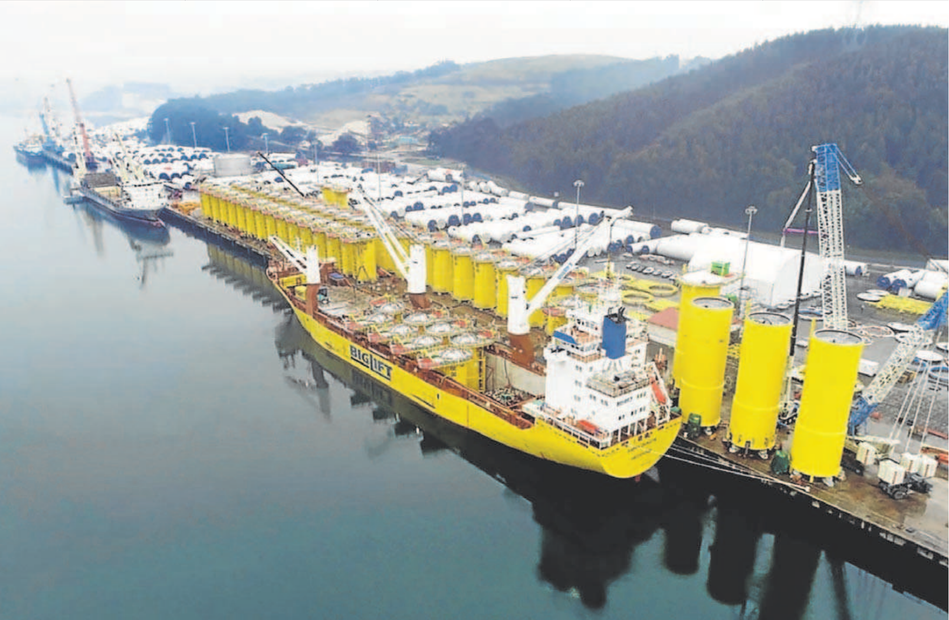
Buque en Avilés con las piezas de transición para el parque eólico marino Baltic, situado en Alemania.
