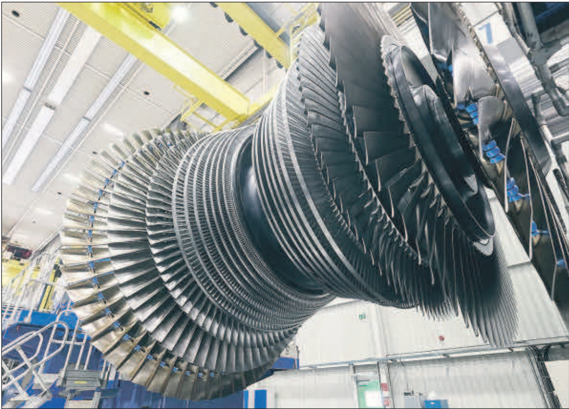
Fabricación de rotores para turbinas de vapor, en Mülheim (Alemania). EE
