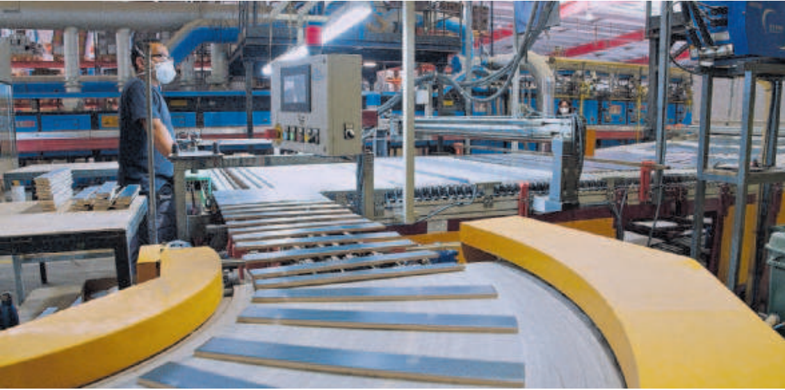
Un empleado supervisa las baldosas de formato pequeño fabricadas en el nuevo horno eléctrico de Equipe, en Onda (Castellón). CEDIDA POR IBERDROLA
