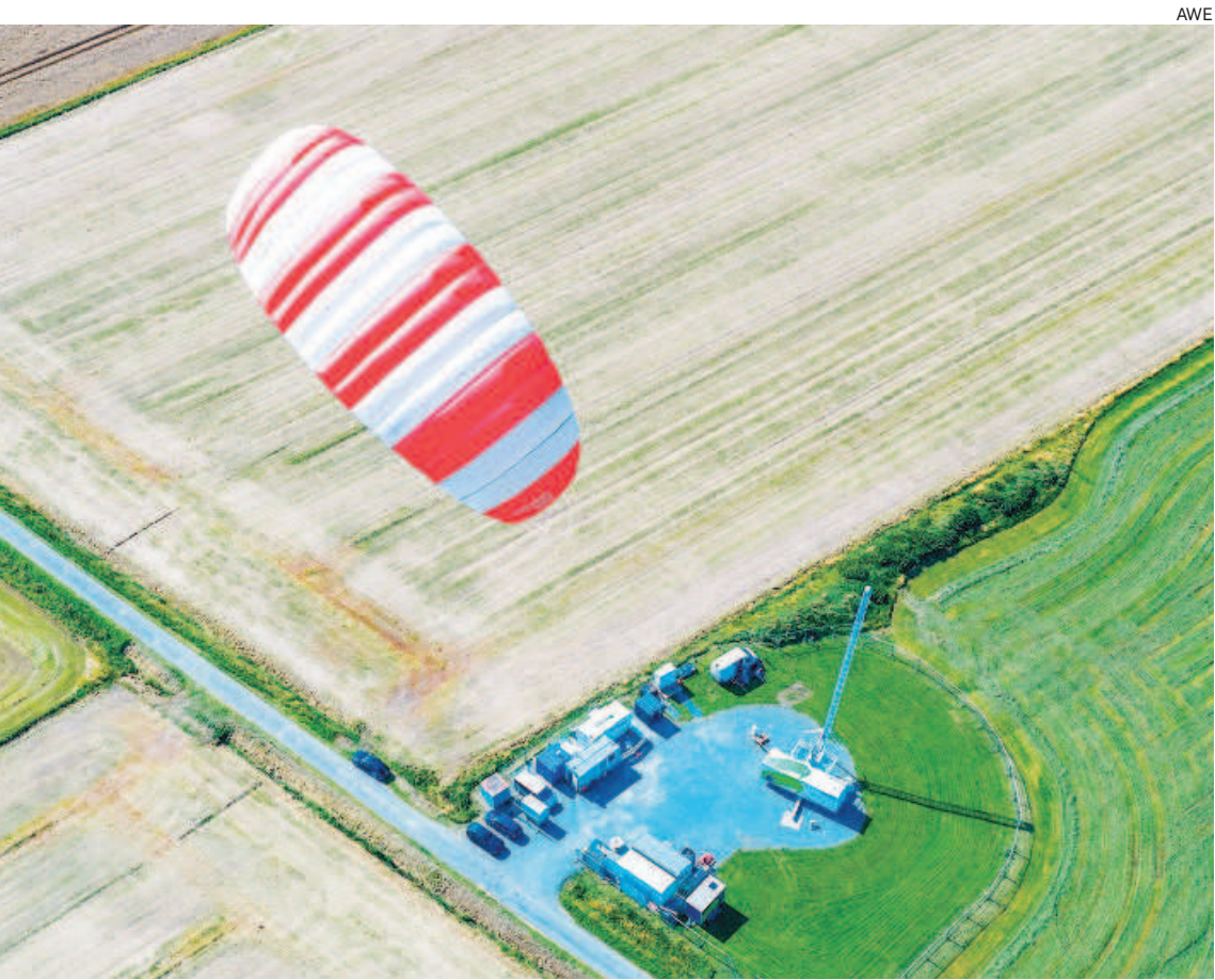
Vista desde el aire de una instalación de eólica aerotransportada en el campo
