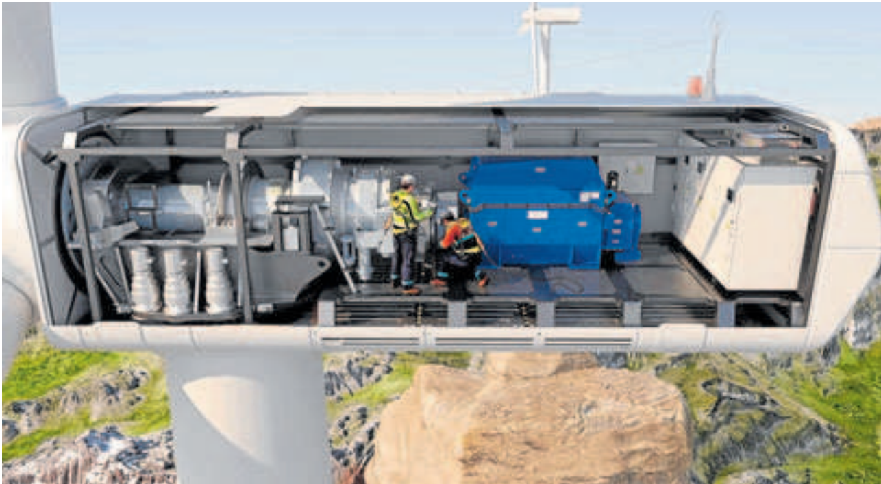
Simulación del interior de una góndola con el generador y convertidor de Ingeteam.
