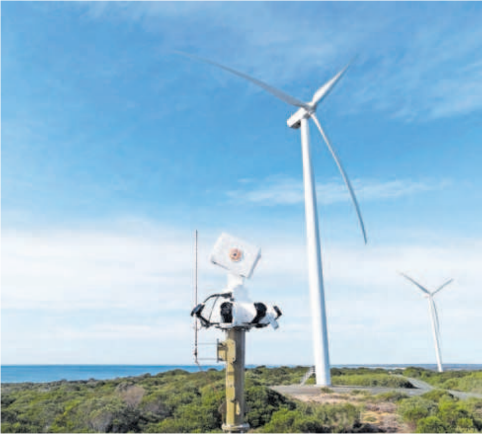
Torre del sistema IdentiFlight en un parque eólico. CEDIDA POR ZEFIRO PARTNERS
