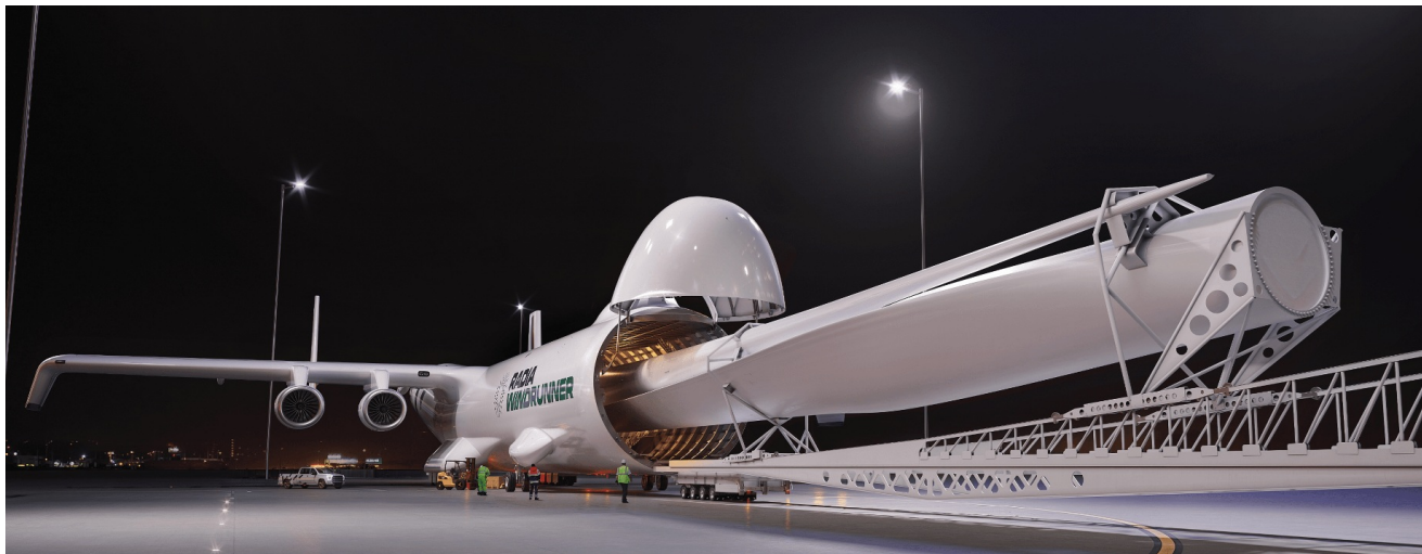
WindRunner, el avión más grande del mundo con el que Radia quiere transportar palas de turbinas eólicas
