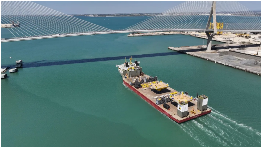
Buque cargado con infraestructuras eólicas marinas (módulos de conexión subestación-base) parte de los astilleros de Puerto Real (Cádiz) con rumbo a Estados Unidos
