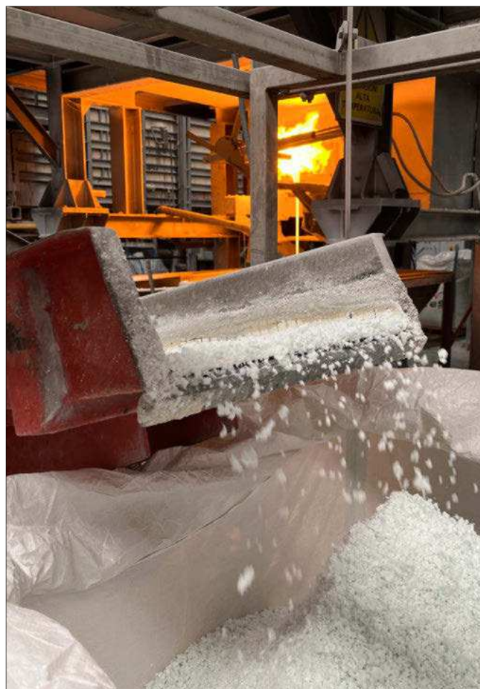
Proceso de producción de fritas en una instalación industrial. C. A. D.
