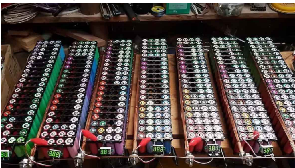
Paquetes de pilas recicladas ensambladas para un sistema casero de autoconsumo energético
